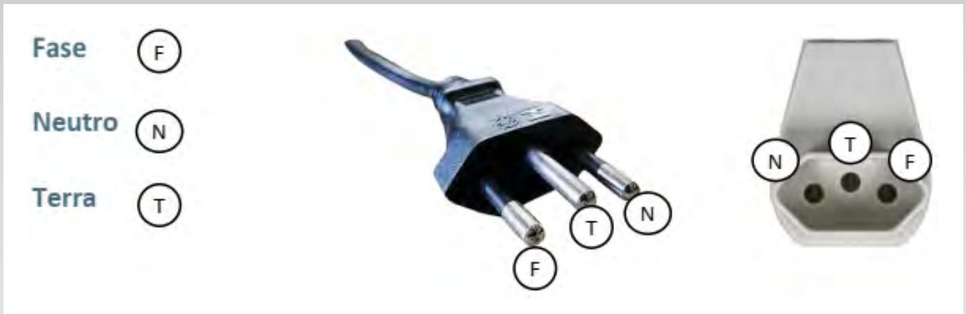
Figura 20: Plug monofásico: recomenda-se o uso do Plug NBR 14136:2002 20A110/220V.
