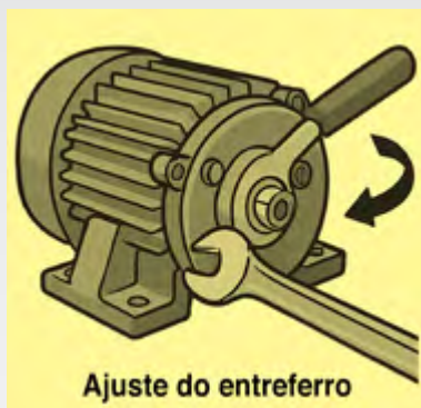
Figura 38: Ajuste do entreferro do freio eletromagnético. Fonte: autor
