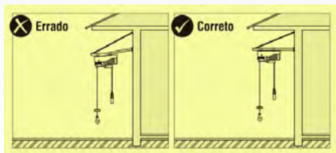
Figura 29: Condição de operação: nivelamento do guincho. Fonte: Vonder 2022
