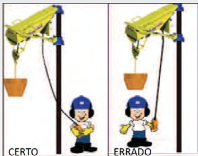
Figura 28: Condição de operação: nunca ter circulação ou presença de pessoas na área de trabalho do equipamento. Fonte: Menegotti 2022
