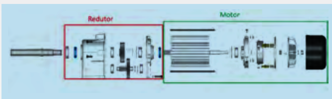
Figura 9: Exemplo de redutor em conjunto com motor para guincho, em vista explodida. Fonte: Autor
