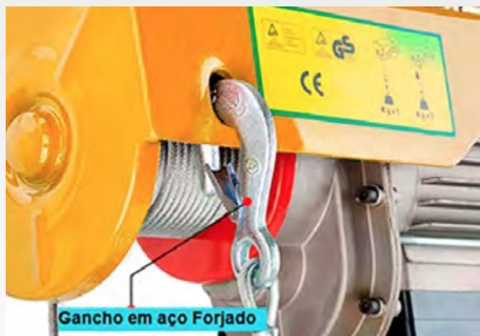
Figura 14: Gancho em posição de uso com polia inversora no guincho de coluna. (Fonte: Autor)
