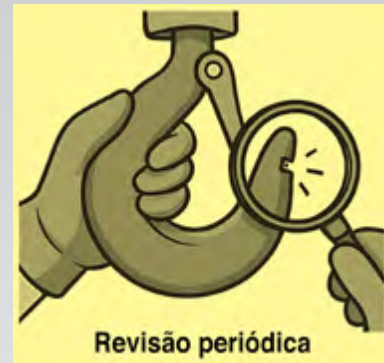
Figura 35: Inspeção necessária de gancho. Fonte: Autor
