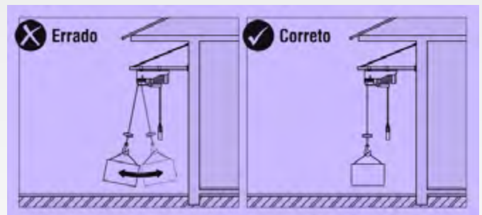
Figura 25: Condição de operação a ser evitada: movimento pendular da carga. Fonte: Vonder 2022
