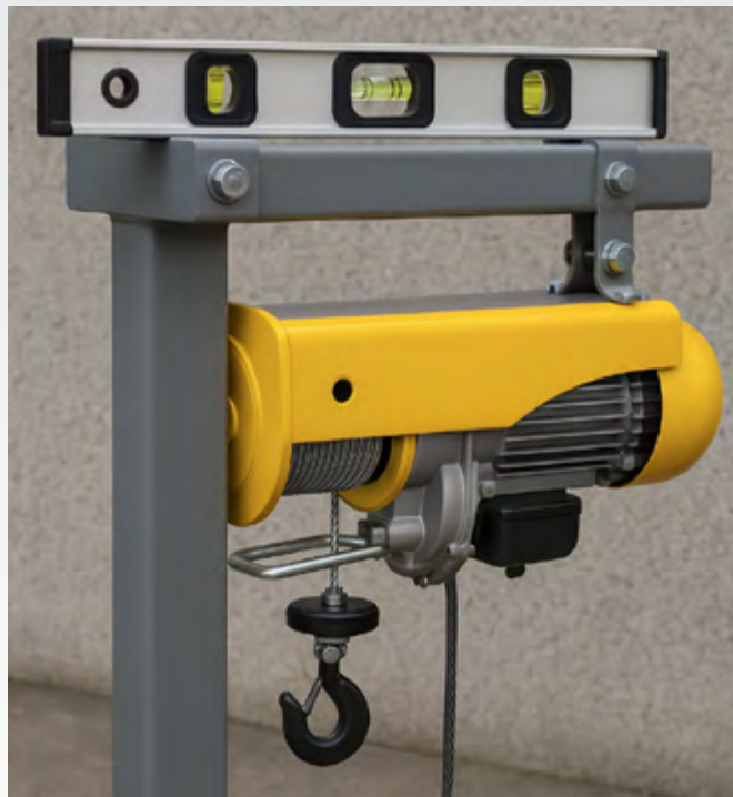
Figura 19: Exemplo de nivelamento de guincho. (Fonte: Autor)
