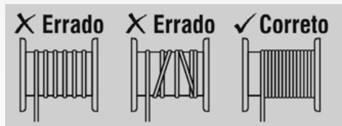
Figura 32: Correto enrolamento do cabo no tambor. Fonte: Vonder 2022
