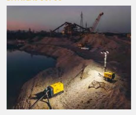
A torre de iluminação HiLight V5+ da Atlas Copco se destaca pela eficiência luminosa, robustez e baixo custo operacional, sendo ideal para mineração, eventos e construção. Possui carenagem HardHat® resistente a impactos e corrosão, estrutura super-silenciada (71,5 dB a 1m) e chassi vedado contra vazamentos. Atende às normas NR 10 e NR 12. tem mastro de 7.5m e ilumina 5.000m² com projetores LED de 30.000h de vida útil. Com consumo de 0,45L/h, oferece 240h de autonomia e manutenção a cada 600h.
