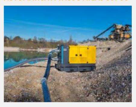
Para enfrentar chuvas intensas, a Atlas Copco destaca a motobomba a diesel PAS 150HF (6"x6"), equipada com escorva automática a vácuo, capaz de bombear até 600m³/h e atingir 50m de altura. Portátil e de fácil operação, dispensa estruturas de apoio e lida com líquidos que contenham sólidos, tornando-se ideal para drenagens emergenciais em indústrias, condomínios e obras.
