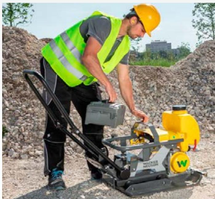
Figura 5 – Substituição de bateria em placa vibratória elétrica.
